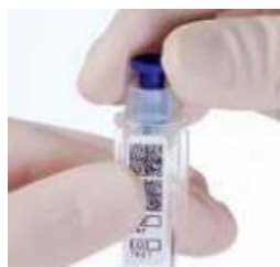
Figur 1 Luk kuvetten helt tæt med CRP reagenslåg. Tryk ikke den inderste del af låget ned
